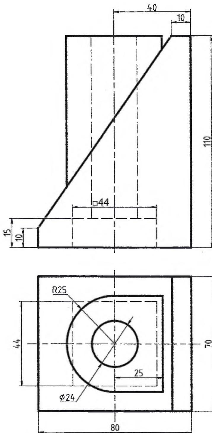
Постройте три вида детали. Половину вида слева замените разрезом. Выполните аксонометрическую проекцию детали с вырезом  $\frac{1}{4}$  части
